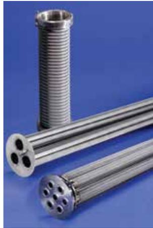
管状反冲洗过滤器有很多选择。钢丝网或织物在不锈钢背面是两个成本有效的解决方案。高强度开槽楔丝元件适用于更多的磨料应用。
