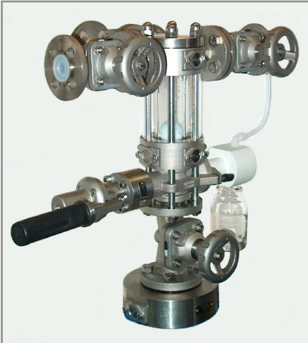
SRS-P 手动操作, PFA 内衬, 带 SDV 1"隔膜切断阀, 通过带 90°C 驱动 GL45 型适配器的 SIV 在线取样阀进行取样
