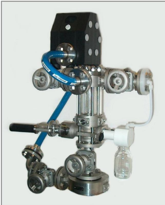
**SRS-P-P** 带 PTFE-AS 隔膜阀，不锈钢系统组件和阀门/PFA 内衬，切断阀 1"隔膜阀，通过带 90°驱动 GL45 型适配器的 SIV 在线取样阀进行取样，介质回流，即循环流程通过高弹性的 PTFE 衬里软管
